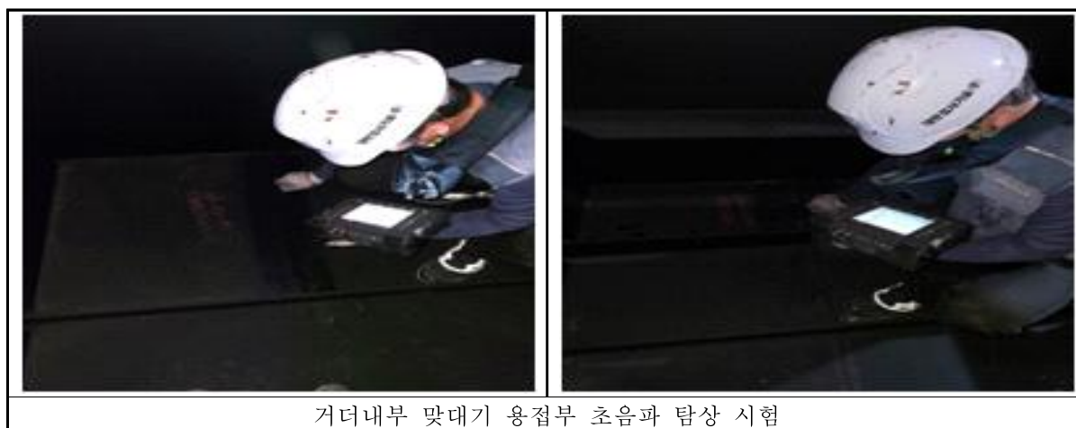
&lt;그림 3.20&gt; 초음파 탐상(사각법) 시험
