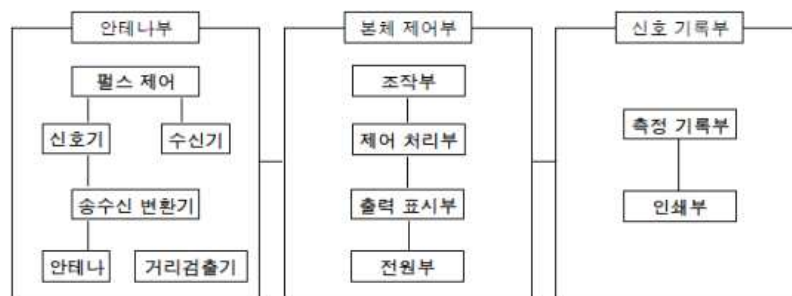
<그림 3.15> 전자파 레이더법에 의한 철근탐사장비의 장치 구성도
