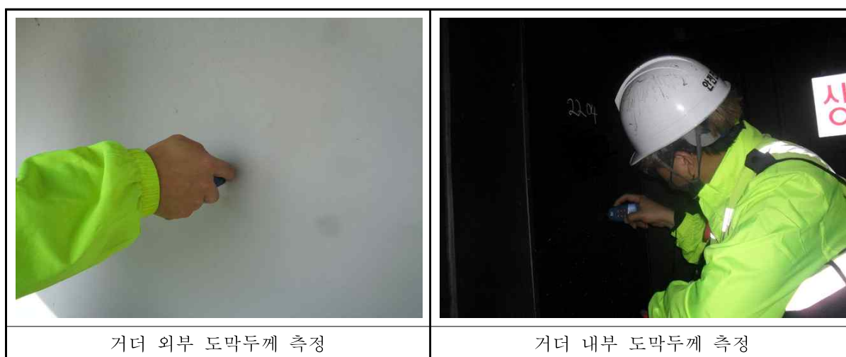
&lt;그림 3.21&gt; 도막두께 측정
