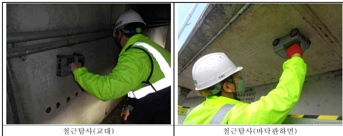
<그림 3.15> 철근탐사 시험
